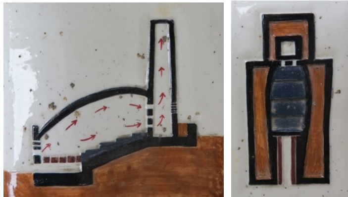
將蛇窯結構縮小的橫焰窯
