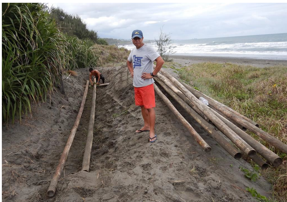
都歷部落將削完竹皮的麻竹桿埋在高位沙灘並鋪上粗鹽一個月後取出 圖為第三作者阮文彬先生
