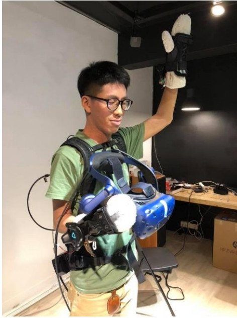
使用者穿戴感應手套、背包型電腦及頭戴式顯示器。
