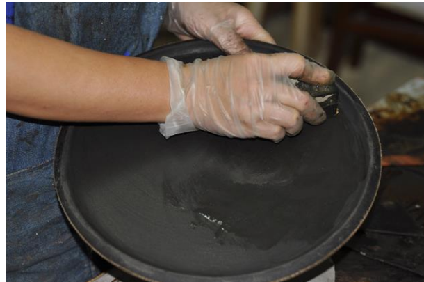
(圖.105) 砂紙水磨漆灰。
