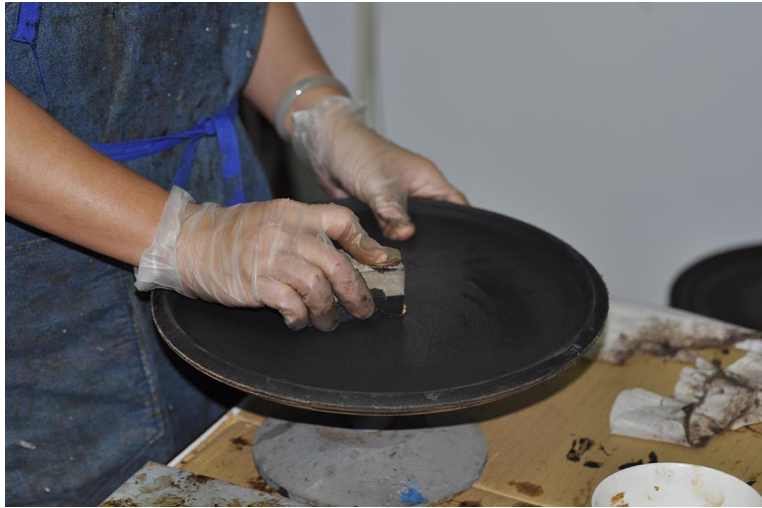
(圖.16)漆灰陰乾後以砂紙水磨。
