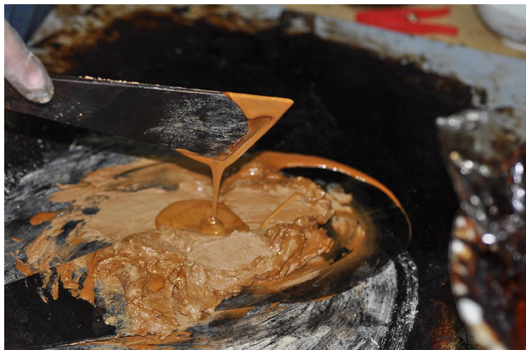
(圖.14)粗/細土粉加水後與生漆拌勻成漆灰。
