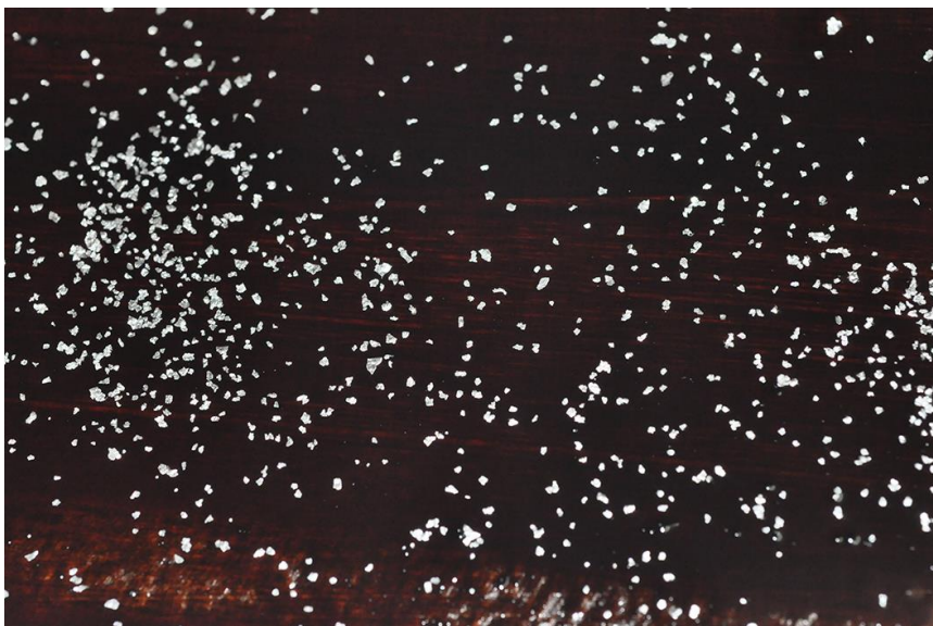
(圖.84) 粉筒撒錫屑，撒時散佈不均。
