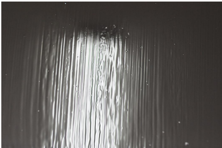
(圖.27) 漆液的流動性不佳，髹漆後漆面會有刷痕。
