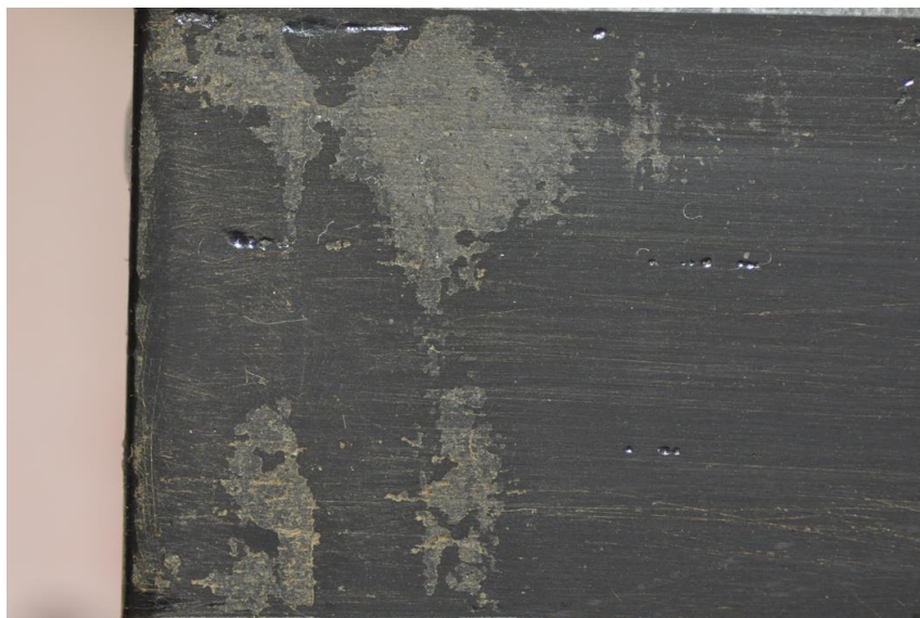
(圖.107) 髹第一層黑漆陰乾後研磨，漆灰層外露。
