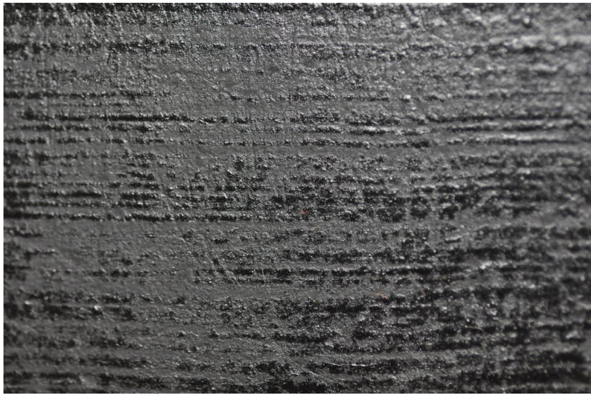
(圖.26) 漆液過稀上不厚，漆層厚度過薄無肉。
