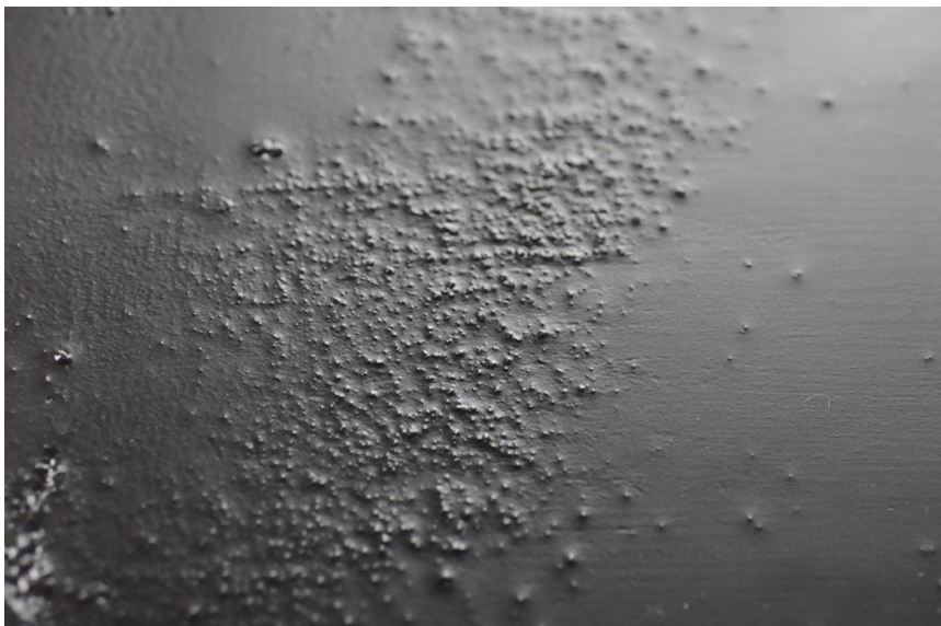
(圖. 37)未以砂紙研磨表面凸起的纖維，直接髹黑漆。
