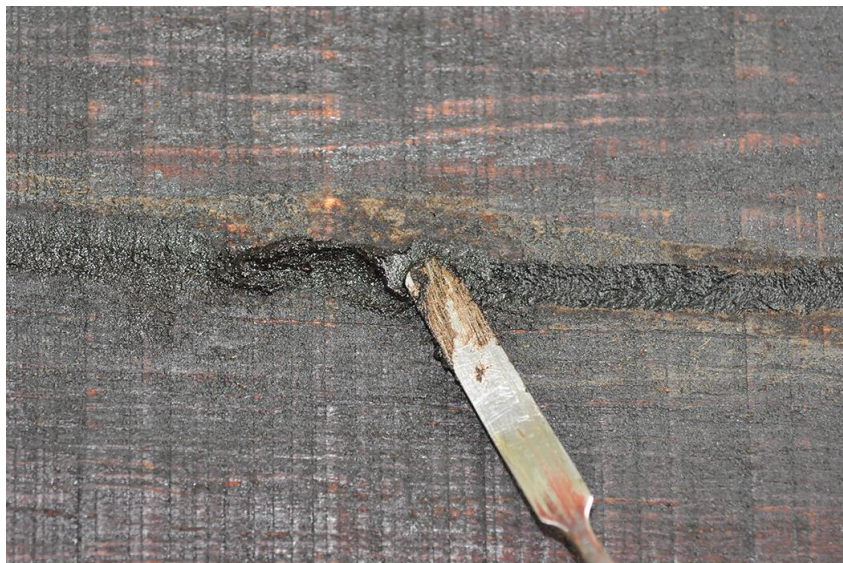
(圖.2)前一層刻苧灰乾後凹陷，再重複填平。
