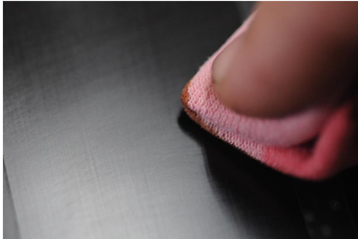
(圖.23)以極薄的生漆擦漆後陰乾。
