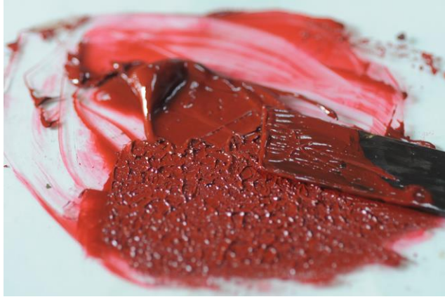
(圖. 89) 絞漆調好後以拍打方式測試是否塌陷。
