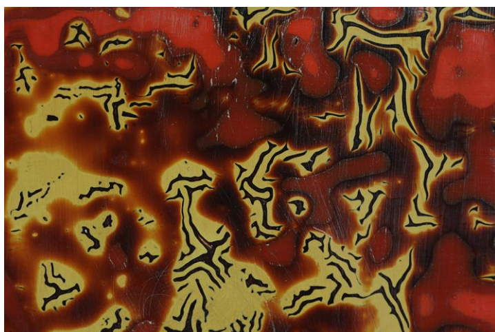
(圖.123) 變塗花紋被砂紙研磨過頭，圖案不均勻。
