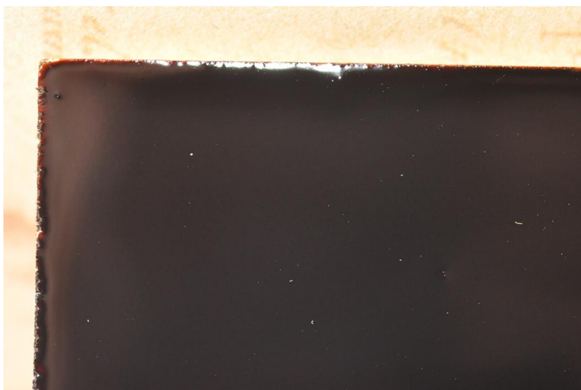
(圖.25) 熟漆加入過多桐油，致使漆面硬度不夠而過於滑軟。
