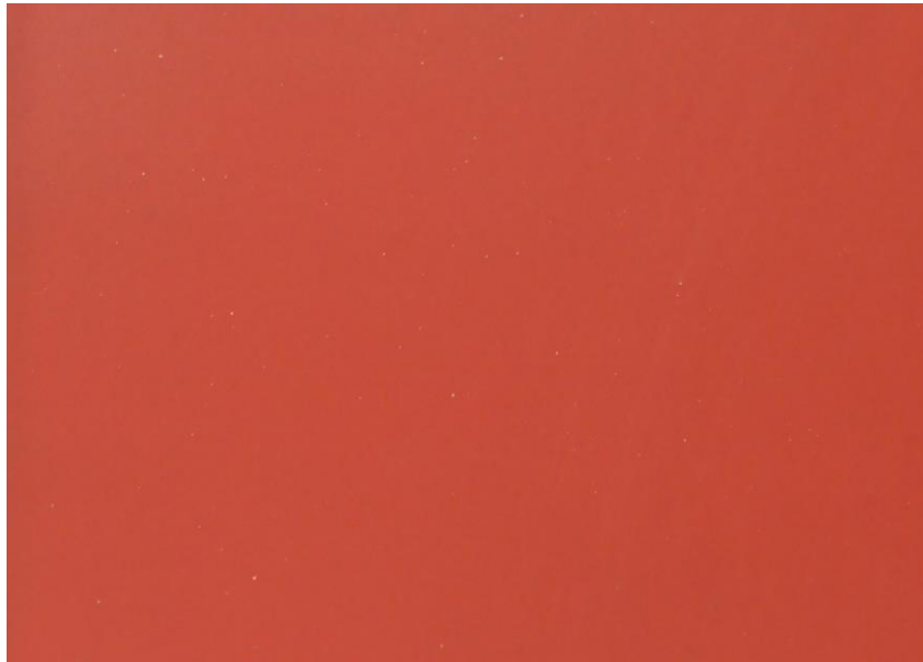
(圖. 66)朱漆以色粉 1：透漆 3 研磨調製。
