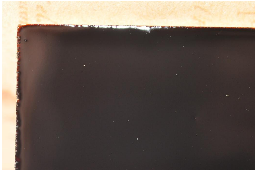
(圖. 39)木板上髹底漆後研磨再髹面漆。
