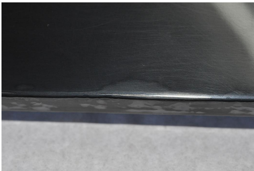
(圖. 109) 中塗黑漆層被磨損，見下塗黑漆層。
