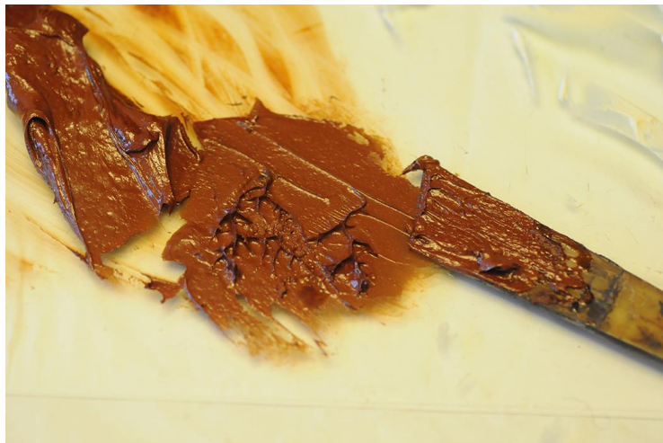
(圖. 97) 絞漆調好後以拍打方式測試是否塌陷。
