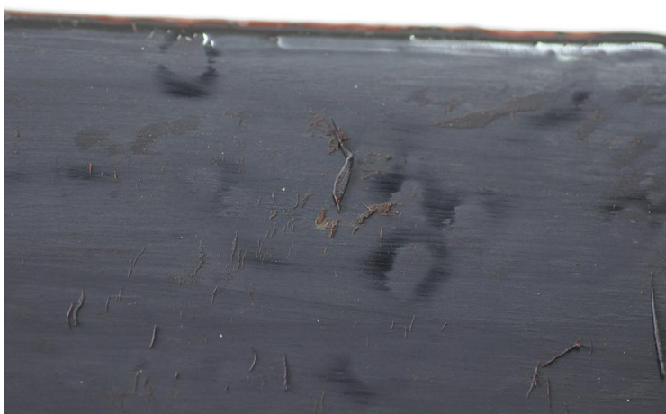
(圖.52) 飛塵未挑去研磨後。
