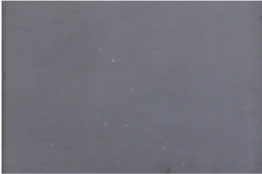
(圖.114) 漆面擦漆推光不足，漆面灰黑不明。
