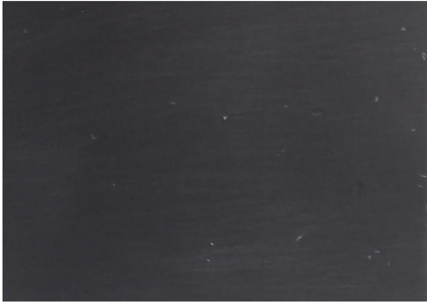
(圖.115) 使用的漆質不佳，推光後的漆面不夠烏黑。
