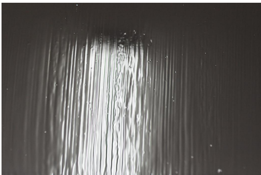
(圖.54) 用過硬的漆刷髹過稠的黑漆，刷痕無法完全流平。
