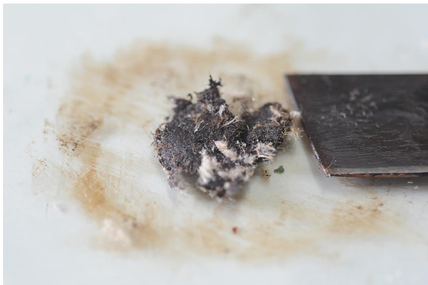
(圖.3)生漆的比例不足，調拌後的刻苧灰如受潮的粗鹽一般。
