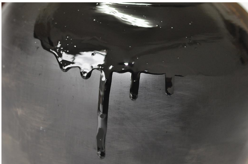
(圖.43) 漆過稀如冰塊溶解垂流。
