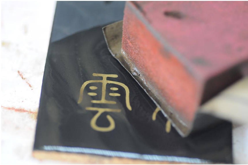
(圖.119) 以砂紙研磨出圖案。
