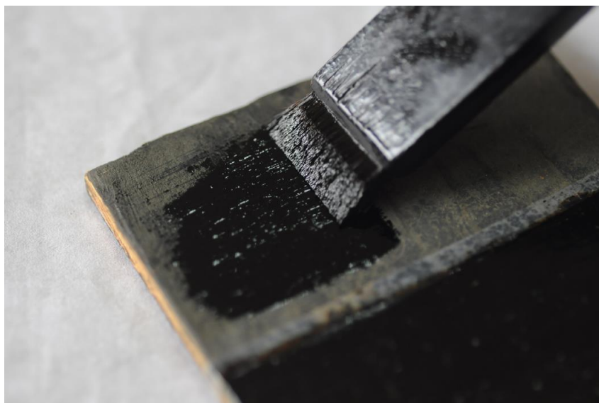
(圖.20)以漆灰打底完成後，用熟漆(黑漆)髹面漆。
