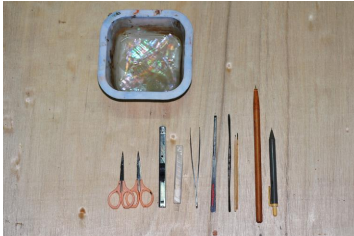
(圖.149) 薄螺鈿泡水軟化再行切割修剪。
