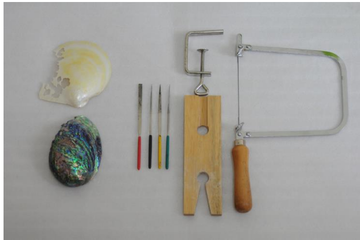
(圖.150) 厚螺鈿以線鋸切割。
