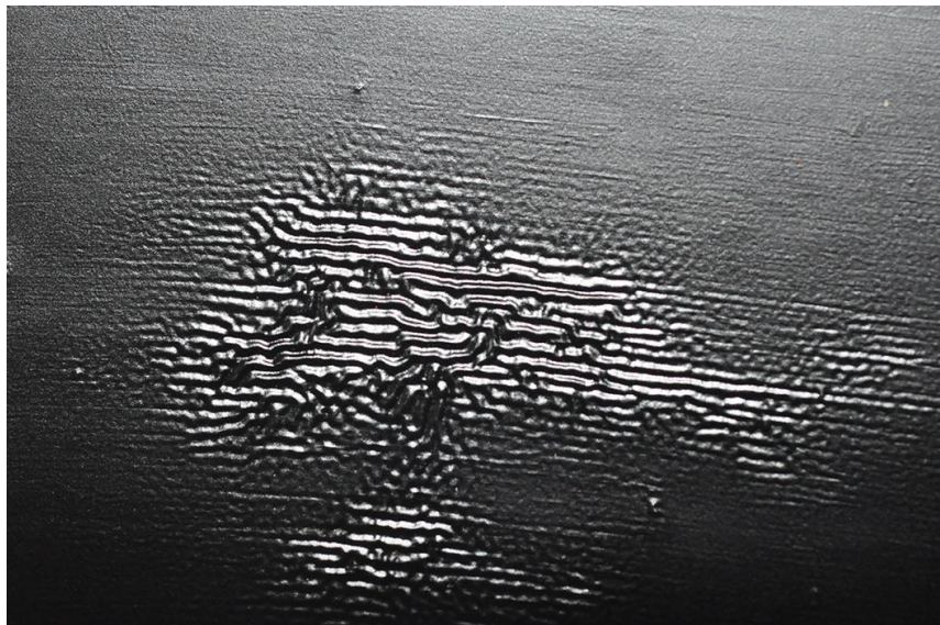
(圖.48) 黑漆髹塗不均，放於高濕度的陰箱陰乾，表面因而起皺。
