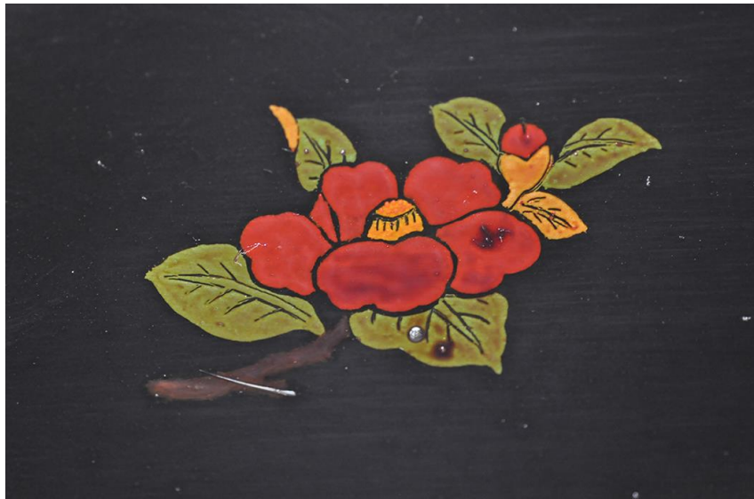
(圖.78) 透漆未過濾，漆面灰塵沾絮周圍如月暈一般。
