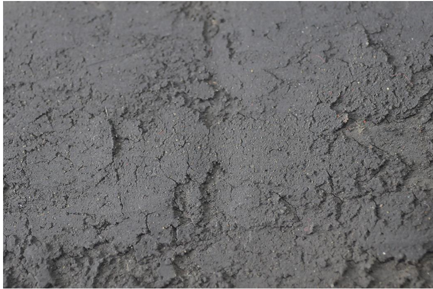
(圖.17)漆灰黏著力不夠，容易因酥鬆脆弱而脫落。
