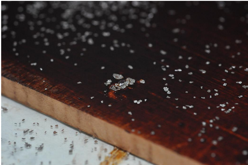
(圖.85) 粉筒撒錫屑，粉屑立起未壓平。
