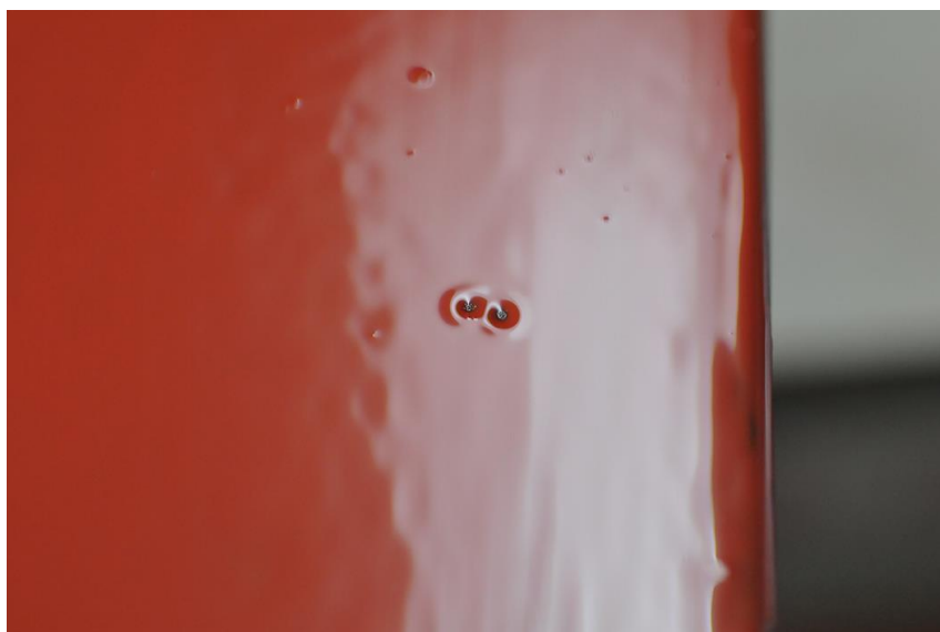
(圖.112) 漆面氣泡未消除，陰乾後留有毛孔。
