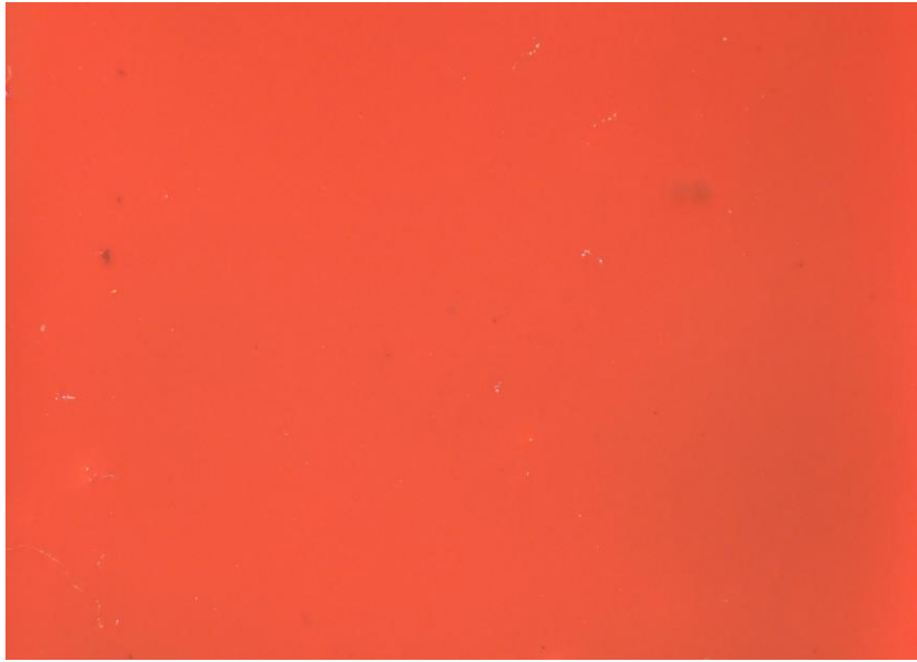
(圖. 63)色漆加入過多桐油混和後髹漆。
