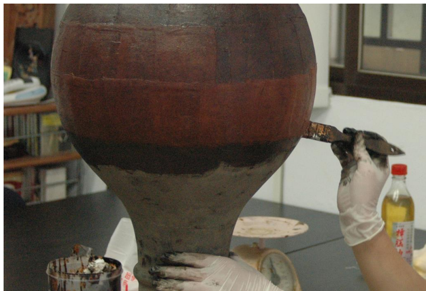
(圖. 30)脫胎夾紵漆器包布接合須密實。
