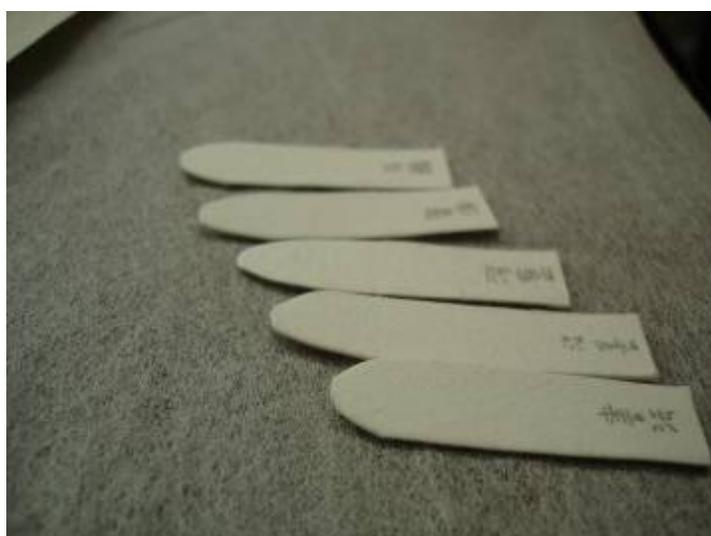
圖 6.將吸水紙剪成圓弧狀點測媒材是否脫落
