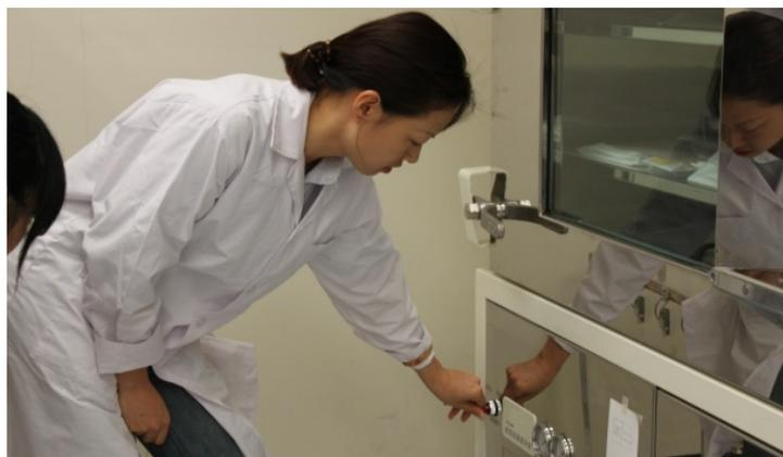
圖 9.置入低氧除蟲設備中進行除蟲
