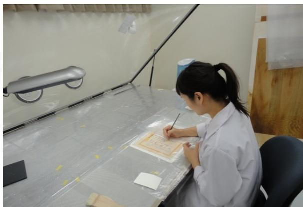
圖 33.藉由抽氣桌增加溶液滲透速度
