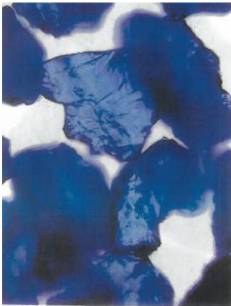
原料・産地 中国新疆(吐魯番・崑崙山麓) 産地 中国新疆 藍銅輝石 Azurite 化学組成物 Cu_2(CO_3)(OH)_2 単斜晶系 硬度 3.5-4.0 比重 3.8 屈折率 1.76
