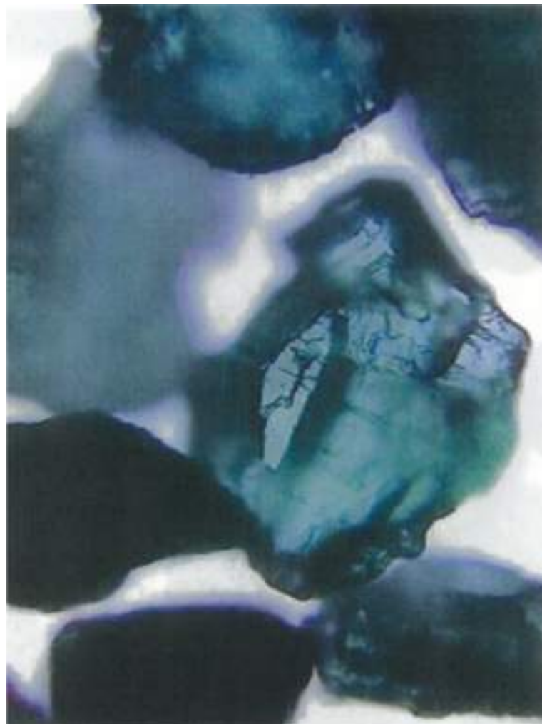
原料・産地 中国新疆(吐魯番) 産地 中国新疆 孔雀石 Malachite 化学組成物 Cu_2(CO_3)(OH)_2 単斜晶系 硬度 3.5-4.0 比重 3.7-3.9 屈折率 1.85-1.91
