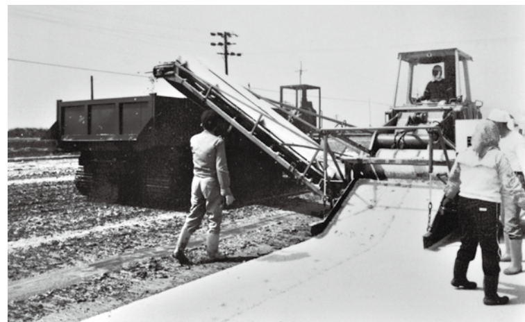
抬高式履帶搬運車與收鹽機同步作業情況。(林允定提供)
