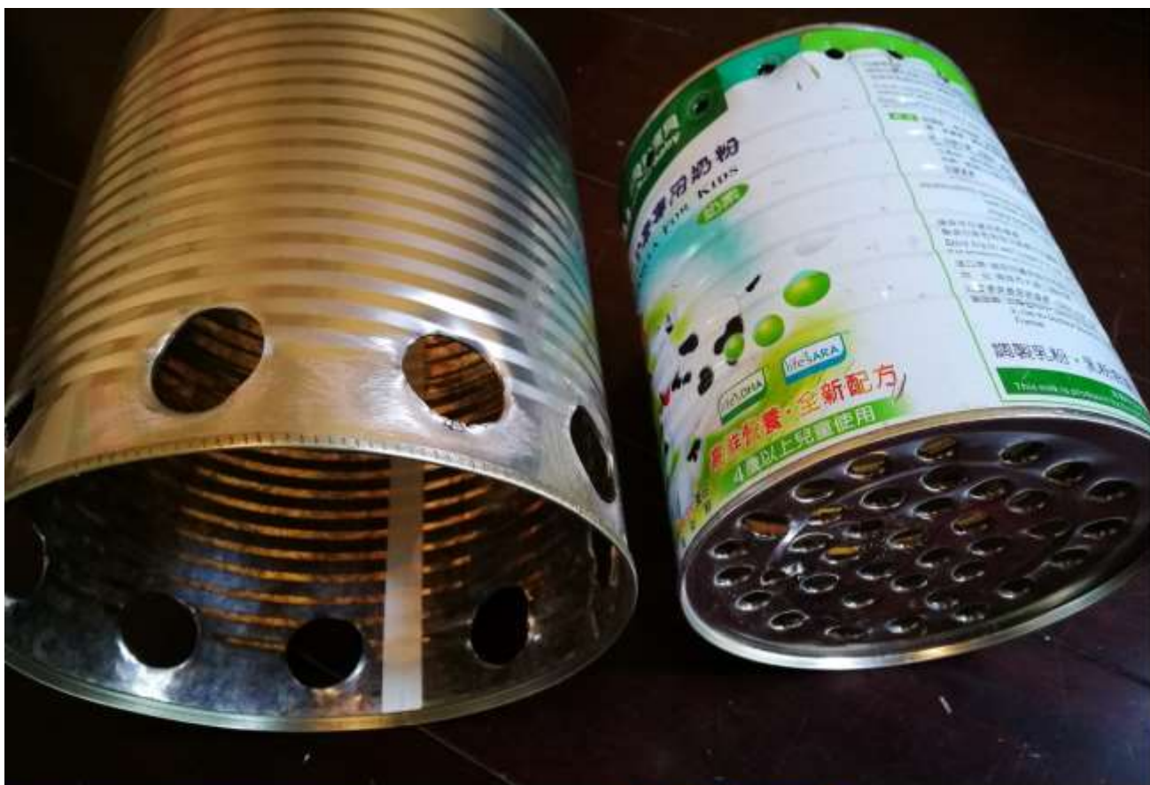
製作汽化爐 材料-回收的鐵桶 烹飪使用
