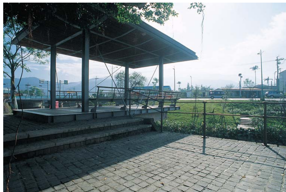
▲出挑的涼亭運用鋼構造加上鍍鋅格柵板，讓水岸設施更為輕巧。
